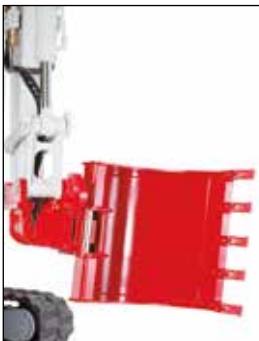
Powertilt mit hydr. Schnellwechsellplatte, Tieflöffel als Hochlöffel montiert
