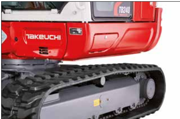
Laufrollen mit Innen- und Aussenführung für sicheren Gummikettenlauf und Double-Short-Pitch Gummiketten für vibrationsarmes Fahren.
