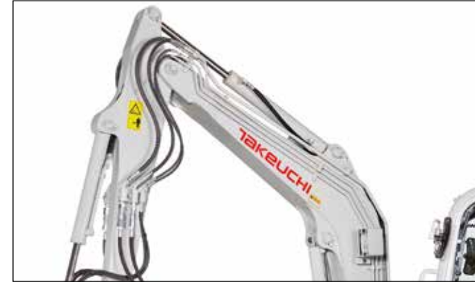
4 Steuerkreise, davon 3 proportional gesteuert, regulierbare Literleistung.
